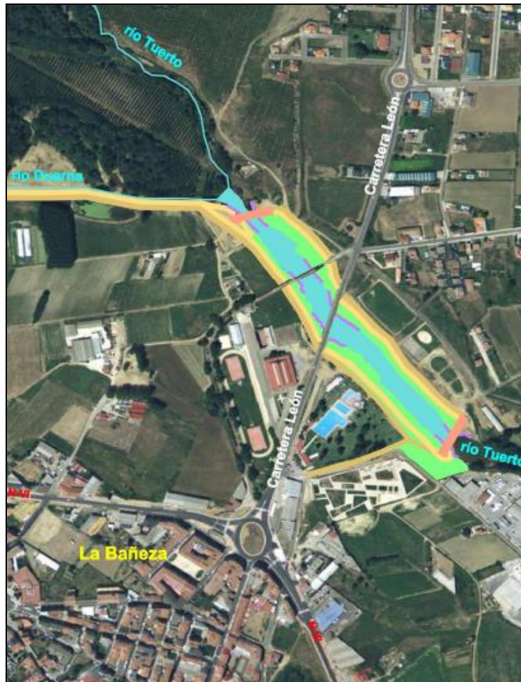
Figura 5. Intervención en el río Tuerto entre La Bañeza y Requejo de la Vega. Fuente: Folleto informativo del Acondicionamiento de las márgenes del río Tuerto en La Bañeza
