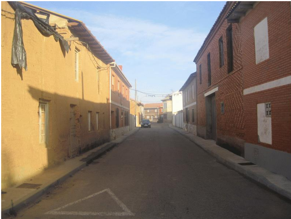
FOTOGRAFÍA 18. Vista de Oteruelo de la Vega, pequeño núcleo con un viario estrecho y fuerte contraste de materiales tradicionales como el adobe y modernos como el ladrillo visto
